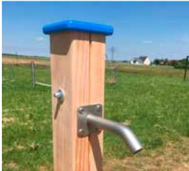
**Wassersäule** (Höhe 1,30 m) aus Douglasienholz, feinjährig, kerngetrennt und geschliffen. Abdeckkappe aus langlebigem PE-Vollkunststoff. Feuerverzinkter, pulverbeschichteter Pfostenschuh aus U-Profil. Mit Dosierer, Schlauchanschluss und Speier aus Edelstahl. Zum Verbau zusammen mit unseren Matschlaboren.
