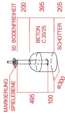
Stoßdämpfender Boden nach DIN 1176
