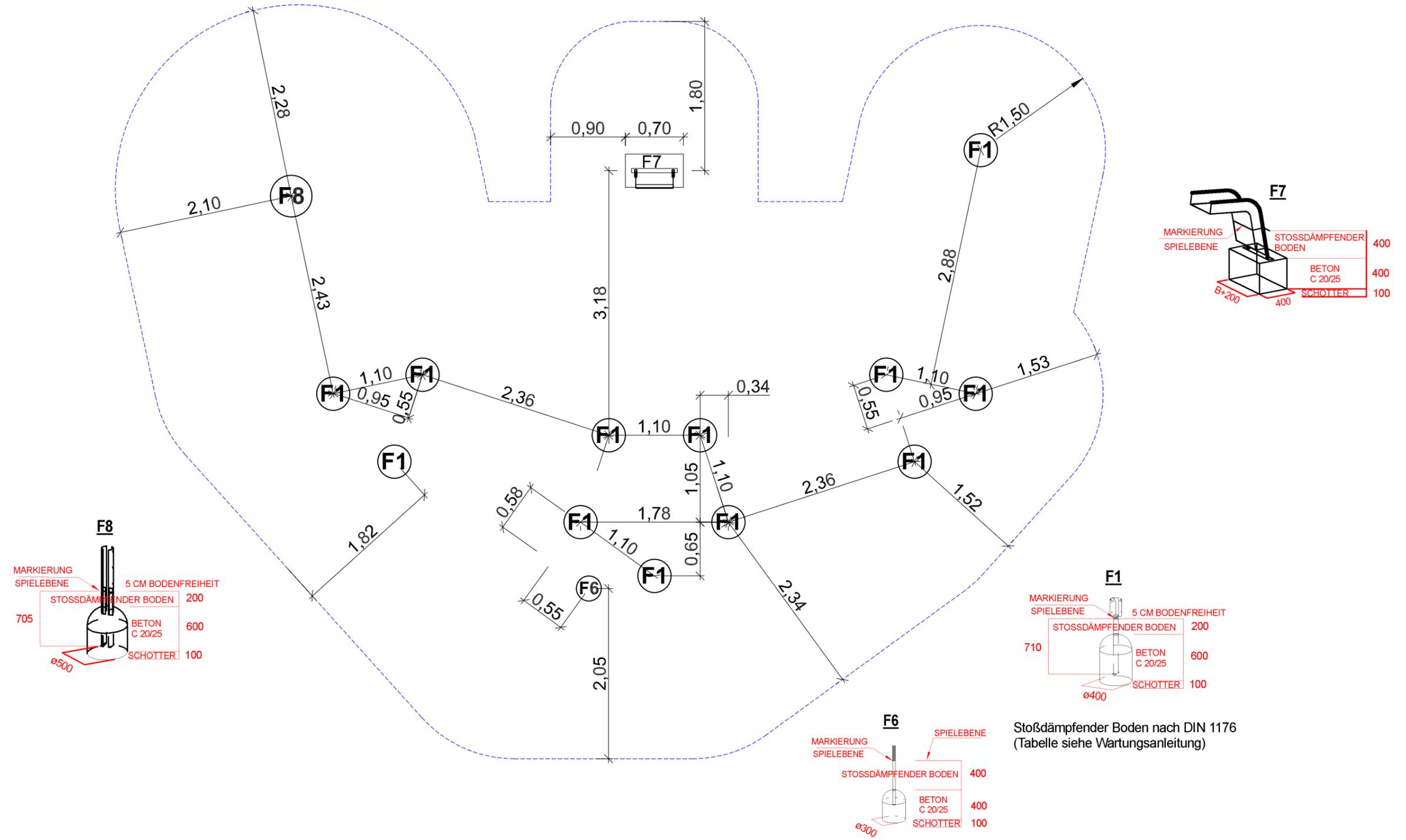
Stoßdämpfender Boden nach DIN 1176
