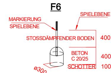
Stoßdämpfer Boden nach DIN 1176
