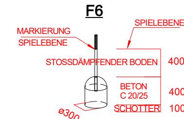
Stoßdämpfender Boden nach DIN 1176
