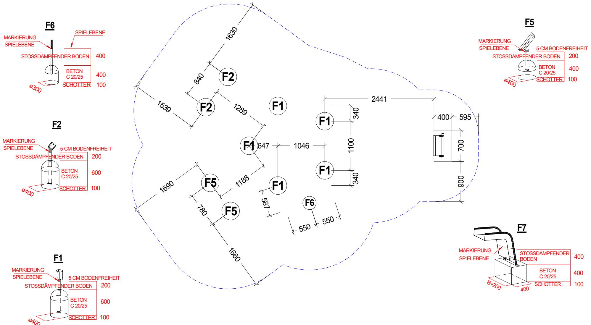
Stoßdämpfender Boden nach DIN 1176
