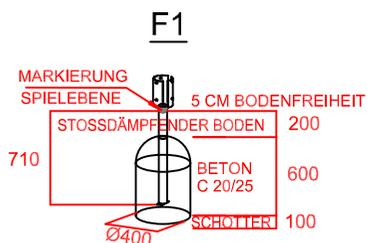
Stoßdämpfender Boden nach DIN 1176
