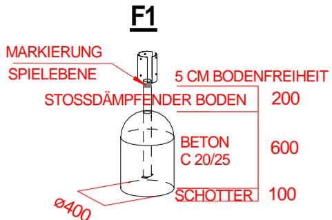
Stoßdämpfender Boden nach DIN 1176
