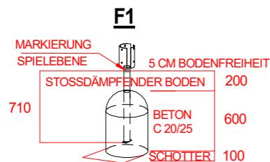
Stoßdämpfender Boden nach DIN 1176
