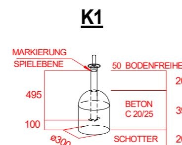
Stoßdämpfender Boden nach DIN 1176
