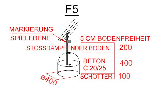
Stoßdämpfender Boden nach DIN 1176
