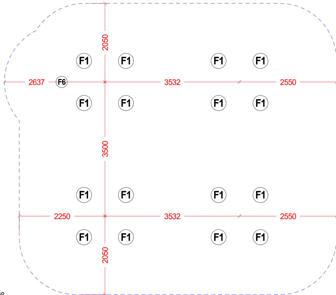
Stoßdämpfender Boden nach DIN 1176
