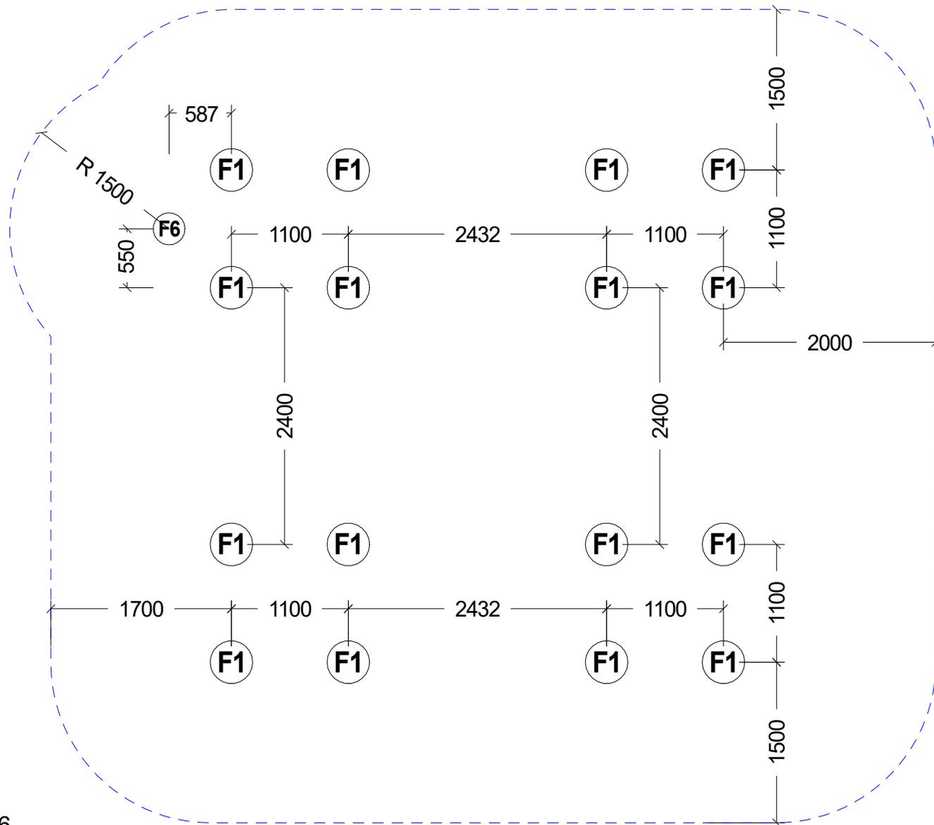
Stoßdämpfender Boden nach DIN 1176
