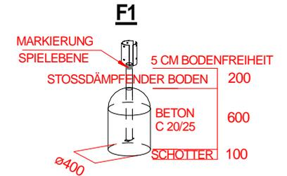
Stoßdämpfender Boden nach DIN 1176
