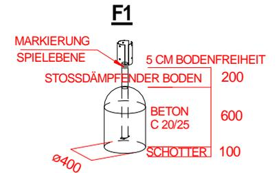
Stoßdämpfender Boden nach DIN 1176
