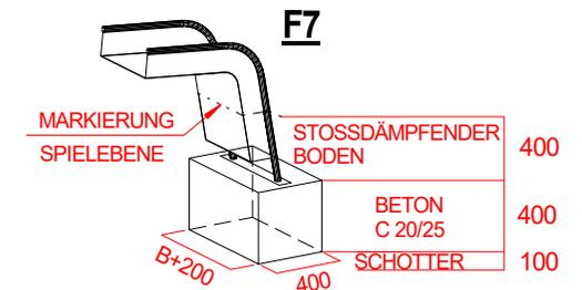
Stoßdämpfender Boden nach DIN 1176
