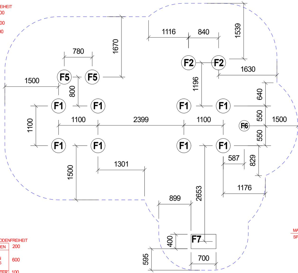
Stoßdämpfender Boden nach DIN 1176
