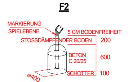
Stoßdämpfender Boden nach DIN 1176
