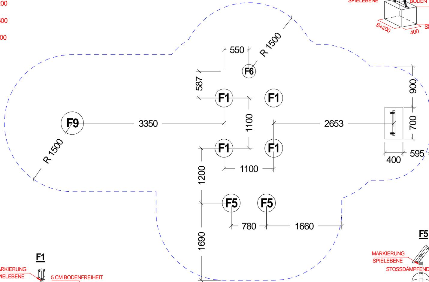
Stoßdämpfender Boden nach DIN 1176
