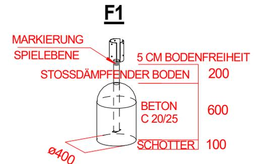
Stoßdämpfender Boden nach DIN 1176
