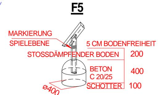
Stoßdämpfender Boden nach DIN 1176
