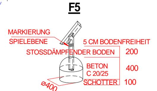
Stoßdämpfender Boden nach DIN 1176
