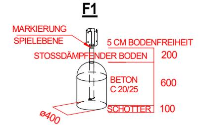
Stoßdämpfender Boden nach DIN 1176
