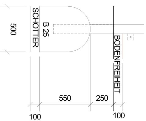
Stoßdämpfender Boden nach DIN 1176
