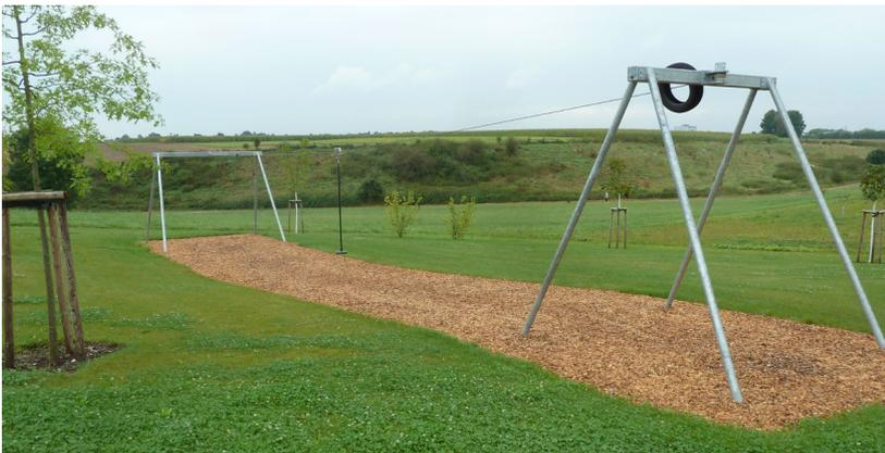
Das Gelände ist so zu gestalten, dass der Abstand zwischen Seilbahnsitz und Boden - unter der Belastung von 69,5 kg - an keiner Stelle weniger als 35 cm beträgt. Um eine geeignete Fahrgeschwindigkeit von höchstens 7 m/s zu erreichen, empfehlen wir nach Tabelle (unten) folgende Werte:
