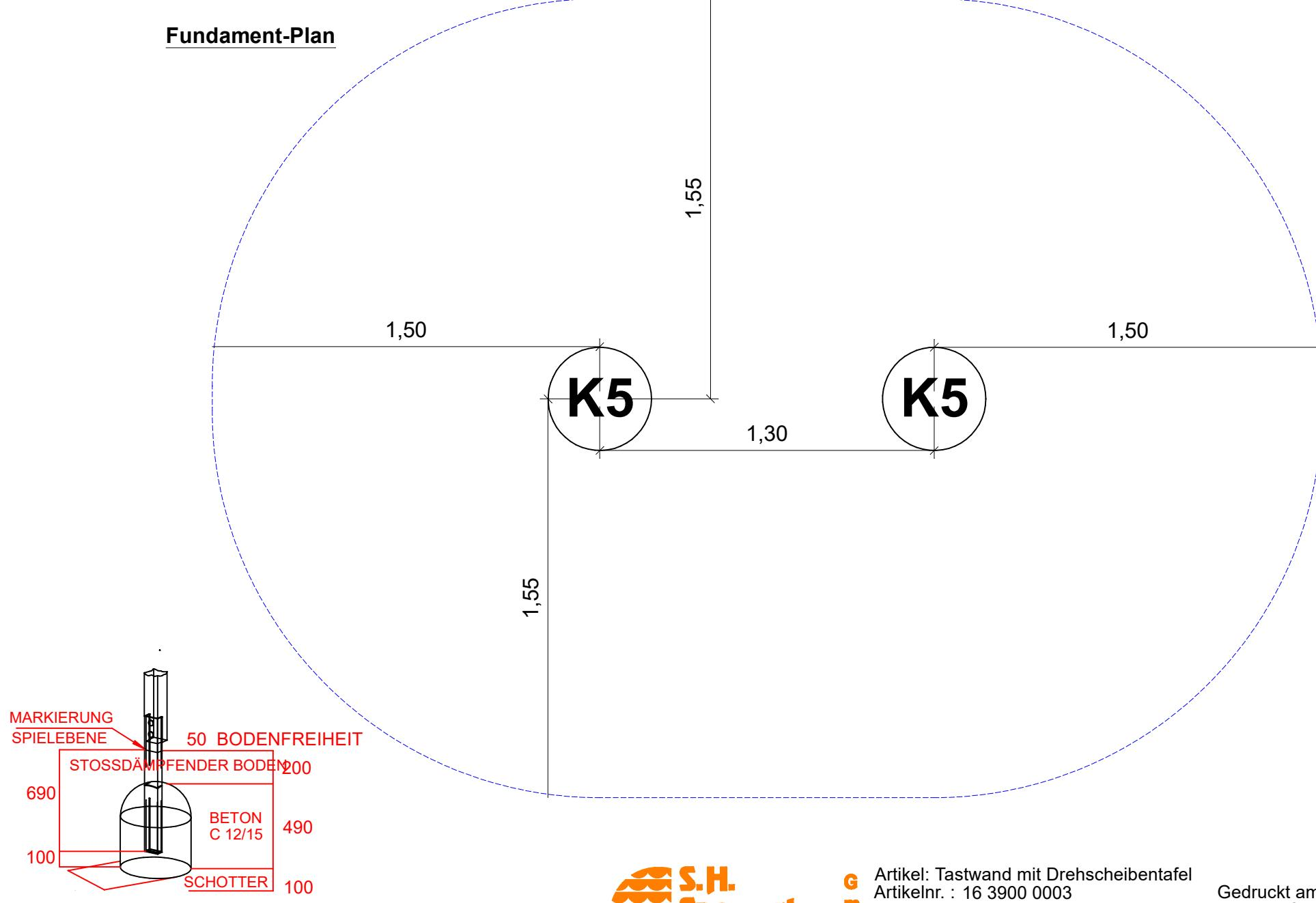
Stoßdämpfender Boden nach DIN 1176
