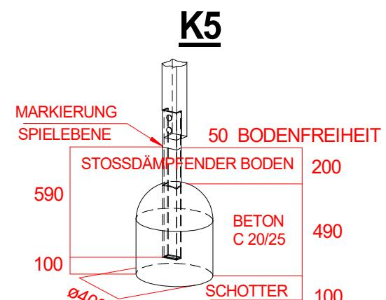
Stoßdämpfender Boden nach DIN 1176
