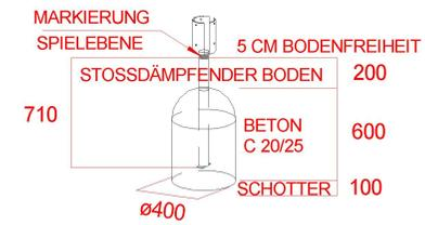
Stoßdämpfender Boden nach DIN 1176
