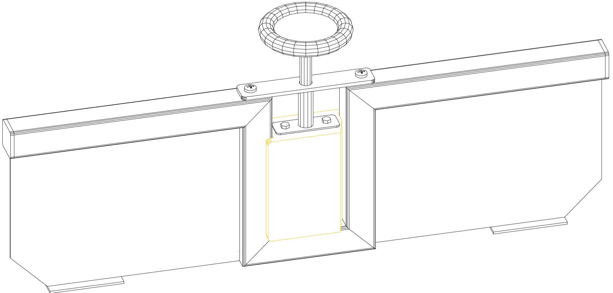
SPG. "Drehwehr zum Einbetonieren"
