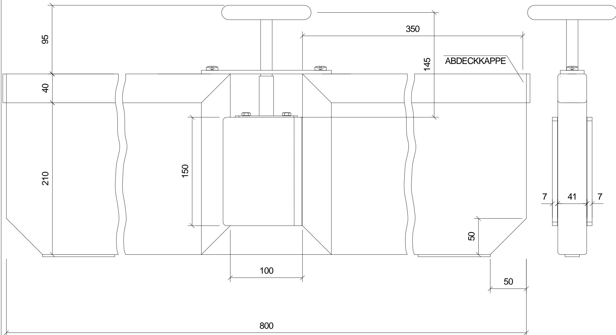
SPG. "Drehwehr zum Einbetonieren"
