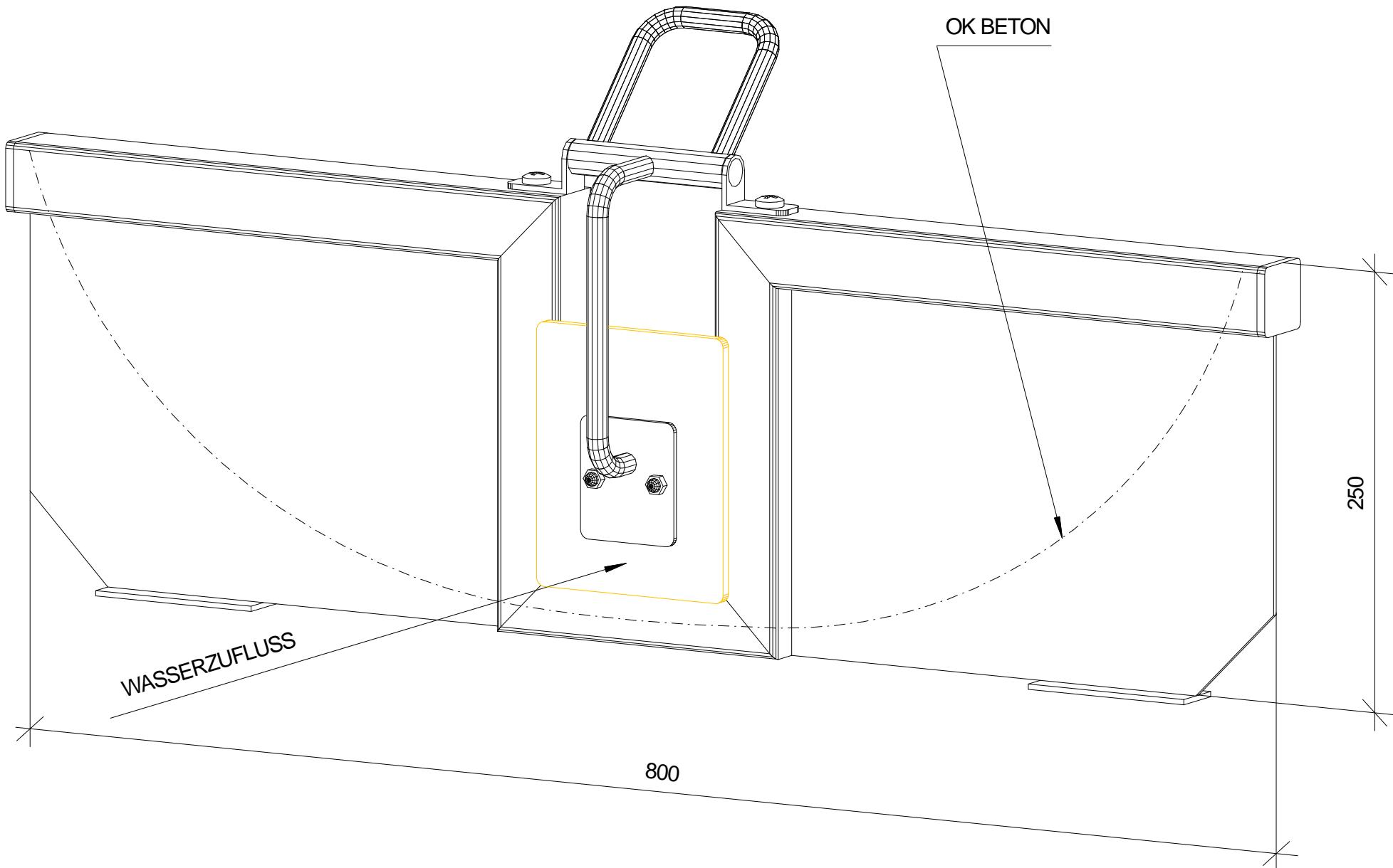
SPG. "Klappe zum Einbetonieren"
