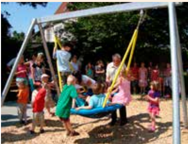
Nestkorb mit Gliedermatte Aufhängung mit schlauchüberzogenen verzinkten Ketten
